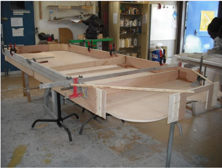
Construction en bois-époxy
